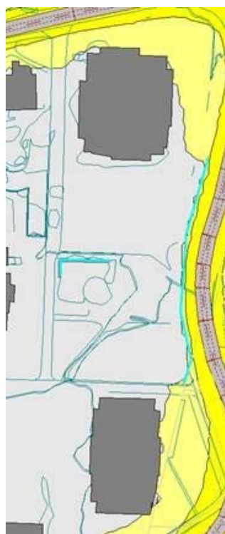
Figur 4: Støynivå uteareal mellom Ola Frost veg 2 og 4 med skjerm vist i turkis strek. Beregnet i 1,5 meters høyde. Fargekoder i henhold til T1442.
