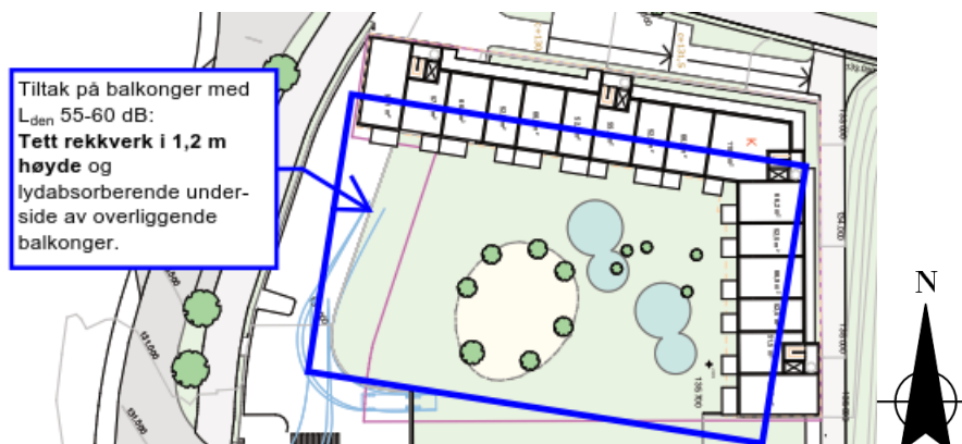
Figur 6: Prinsippskisse for støyskjermende tiltak på balkonger på omsorgsboliger for å oppnå tilfredsstillende støynivå. Utklipp fra vedlegg C.
