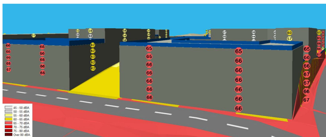
Figur 3. Støynivå fra veitrafikk ved fasade, sett fra sørøst (mest utsatt mhp støy fra veitrafikk).
