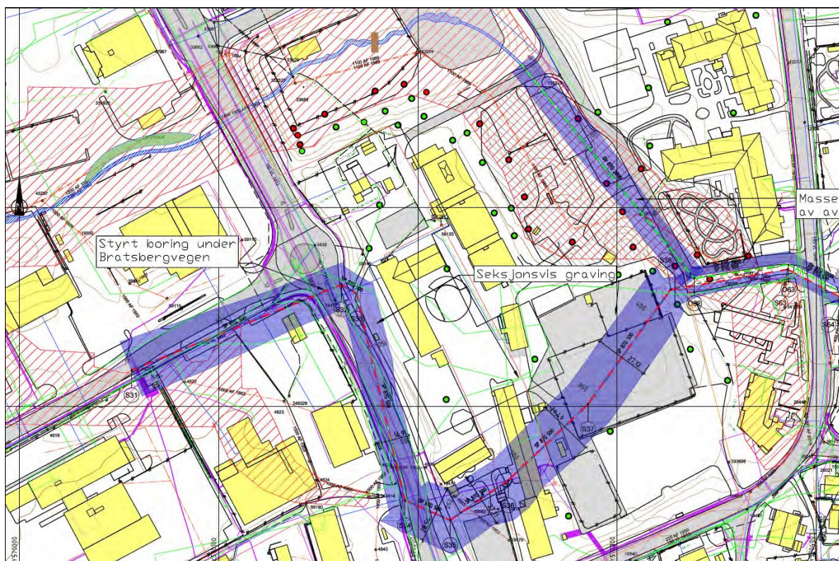
Figur 13: Alternativ 2c: Trase sør for gulbygget. Blått viser beslaglagt areal for VA-grøft. Rød skravur viser antatt utstrekning av avfallsdeponi, basert på boringer gjort av miljøgeologer. Se for øvrig tegning GH008.
