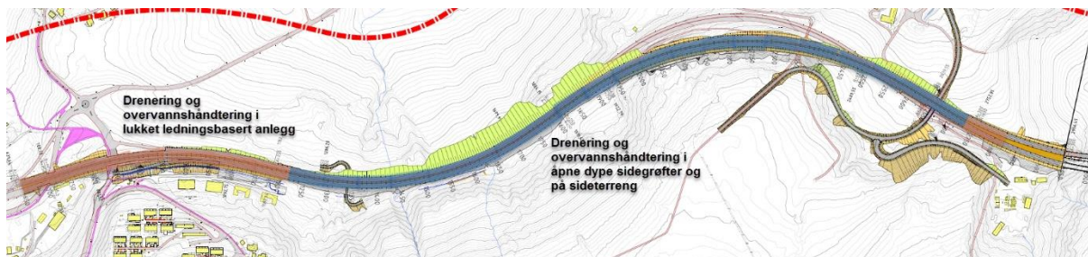
Figur 9 Valg av prinsipper for overvannshåndtering og drenering
