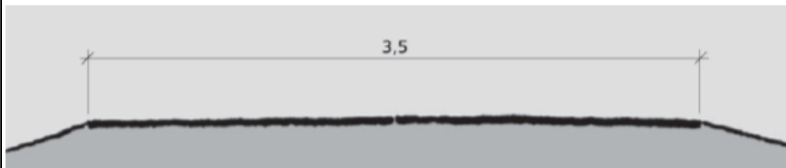
Figur C.20: Tverrprofil A1, 3,5 m vegbredde (mål i m)
