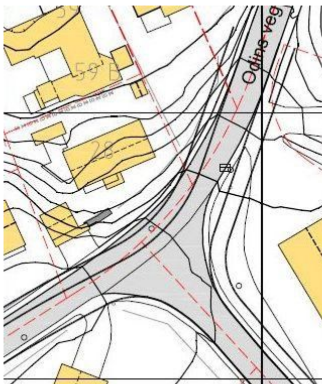
Illustrasjonen viser skisse til ny utforming av kryss mellom Odins veg og Ullins veg. Grått areal er dagens veg, tykkere svarte linjer viser forslag til ny vegutforming.
