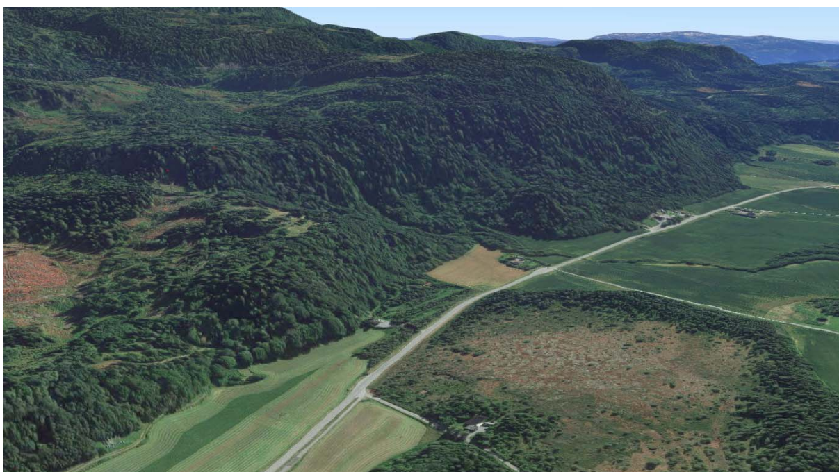
Figur 2: En 3D modell av terrenget viser den aktuelle situasjonen med bratt terreng og en flatt område inn mot vegen. Det flate området vil fungere som en «fang-grøft» ved evt. nedfall. Kilde Google map.
