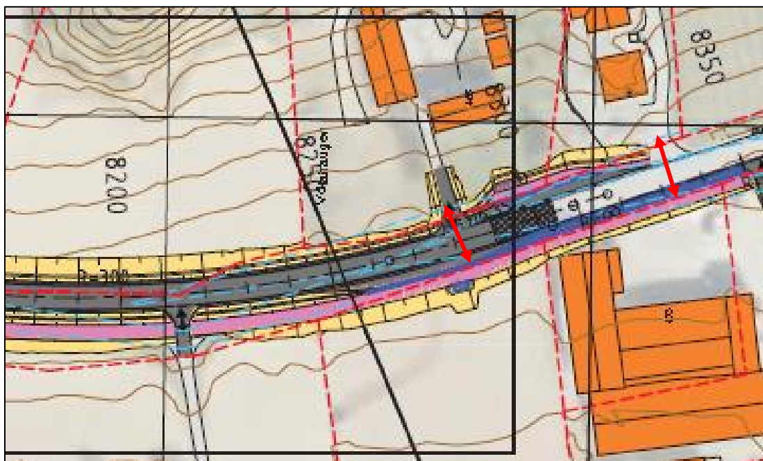
Figur 16 Område med busslommer og kort avstand til gs-veg, avkjørsler på motsatt side
