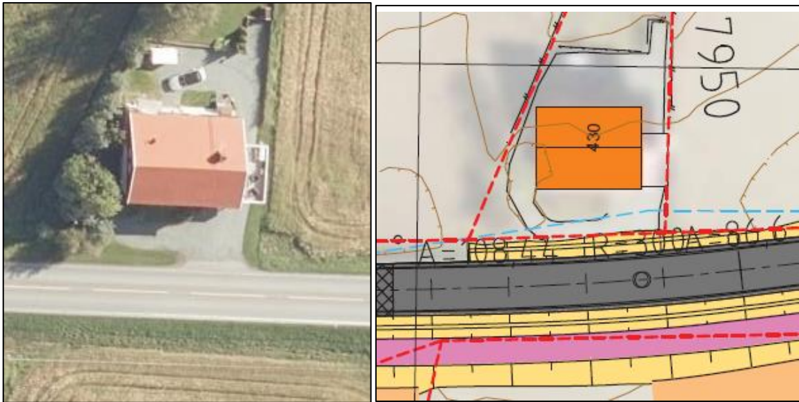
Figur 15 Avkjørsel ved p7930 mangler i planen, og manglende forbindelse med gs-veg på motsatt side (foto: Vegkart.no)
