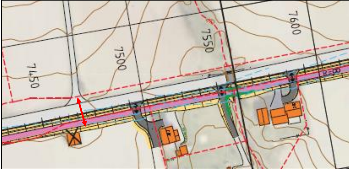
Figur 13 Avkjørsel ved p7470 uten forbindelse med gs-veg på motsatt side, endret avkjørsel ved p7550
