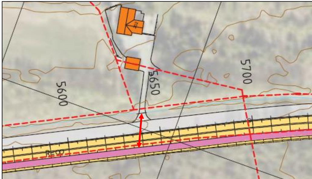
Figur 7 Avkjørsel ved p5640 uten forbindelse med gs-veg på motsatt side
