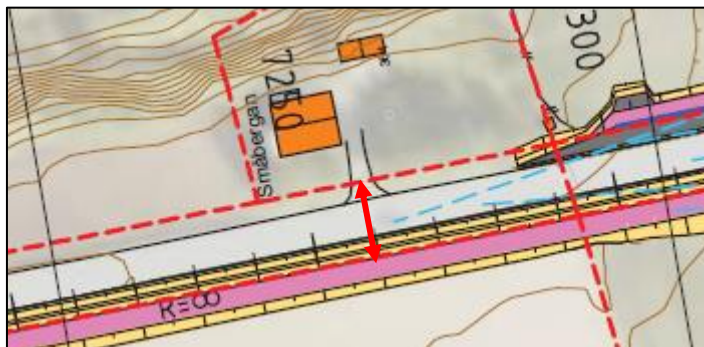
Figur 11 Avkjørsel ved p7260 uten forbindelse med gs-veg på motsatt side
