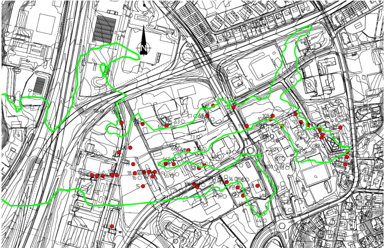
Figur 8. Deponigassundersøkelser i Fredlydalen. Røde felt: Gass påvist ved måling. Hvite felt: Gass ikke påvist ved måling. Lys grønn strek viser omriss av Fredlydalen, basert på kotene fra 1913.
