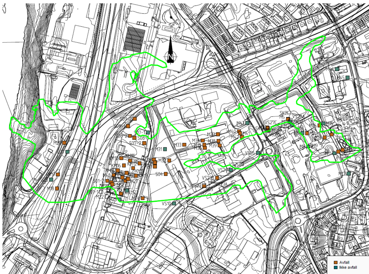
Figur 7. Miljøtekniske grunnundersøkelser ved deponiet i Fredlydalen. Brune firkanter viser prøvepunkt der det er påtruffet avfallsmasser. Grønne felt viser undersøkte prøvepunkt uten avfall. Lys grønn strek viser omrisset av dalen, basert på koter fra 1913.
