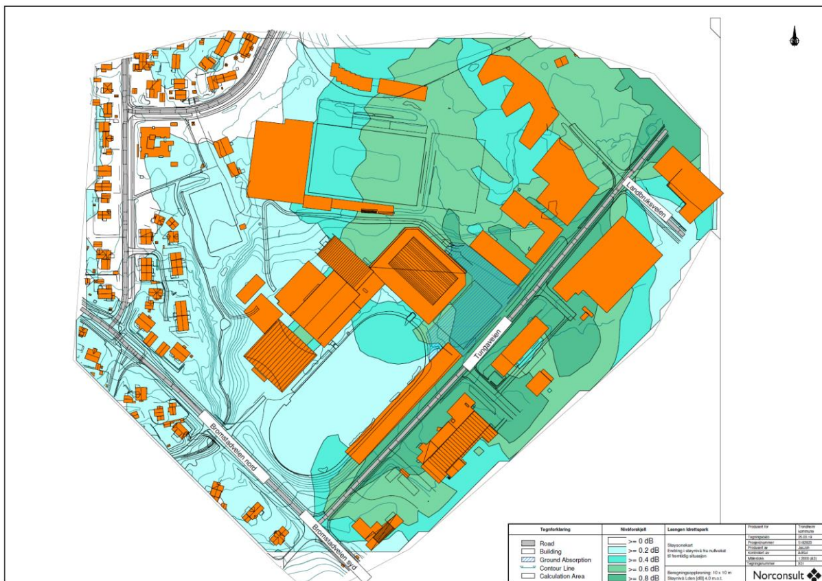
Figur 4 X01 – støykart, differanseplott for vegtrafikkstøy før og etter utvidelsen av idrettsparken.
