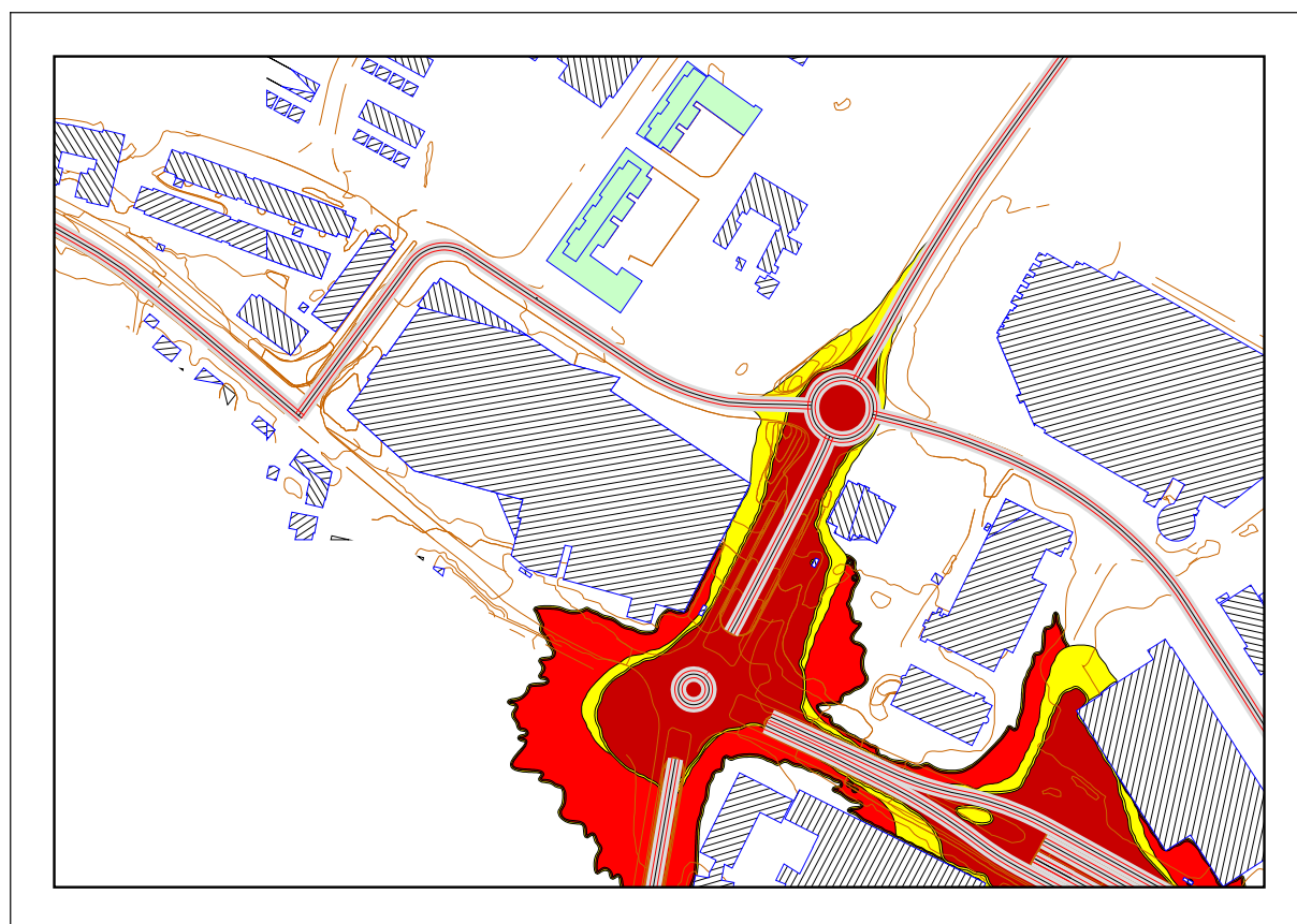
Figur 6-1: Beregnede konsentrasjoner av NO 2 i 2,5 meters høyde med vindrose for år 2012.
