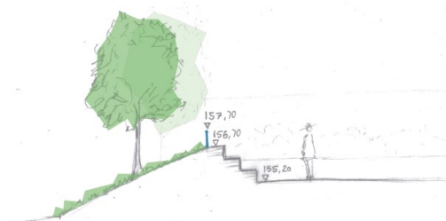
PRINSIPP FOR STØYSKJERMING AV NEDTRAPPET UTEROM Å bruke landskap for å gjøre opplevelse av skjermhøyde så lav som mulig.
