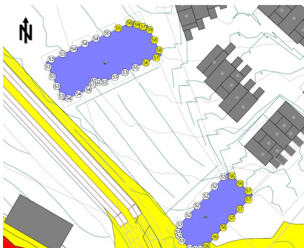
Figur 17: Høyeste fasadenivå, midlertidig situasjon
