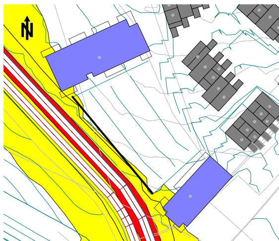
Figur 4-5: Beregnet L_{DEN} 1,5m over terreng for å belyse uteplasser på bakkeplan. Med forslag til skjerm, total utstrekning ca. 52 meter og høyde 1,8 m over opparbeidet terreng. Gul sone: L_{DEN} \geq 55 dB. Rød sone: L_{DEN} \geq 65 dB. Arkitekt vurderer endelig arealkrav mht. stille uteareal per boenhet.
