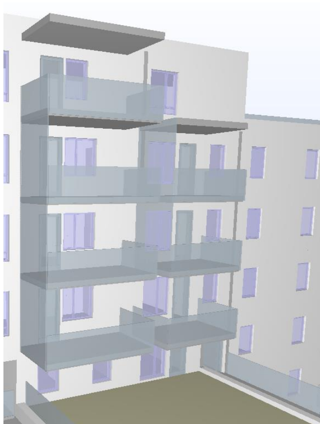
Figur 9: Eksempel på skjerming av balkong for å oppnå L_{den} 55 dB på fasade/balkong. Kan benyttes for å oppnå stille side eller tilfredsstillende støynivå på utendørs oppholdsareal. Illustrasjon fra Veidekkes/Frosts prosjekt Nærbyen på Sorgenfri i Trondheim.
