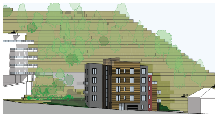
Figur 3 Fasadeoppriss av bebyggelsen mot nord. Gesimshøyder på bebyggelsen er henholdsvis C+61 (Bakkehellet 7), C+51,1 (Bakkehellet 5) og C+38,1 (Bakkehellet 3).
