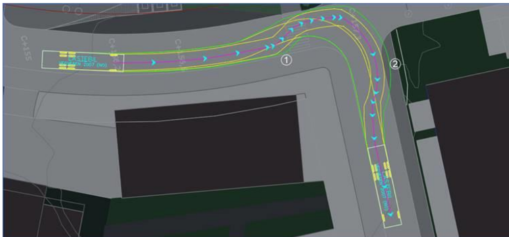
Figur 16 Avsving for lastebil. Gult er hjul, grønt er overheng
