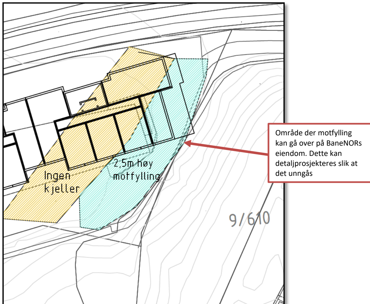
Figur 6-1: utsnitt av plantegning for motfylling i rapport 416232-RIG-RAP-002_rev00. Området hvor planlagt motfylling går inn på nabo eiendom er skissert i figuren. Utbygging som vises i denne figuren er fra opprinnelige planer. Det bemerkes at oppdaterte planer i mye mindre grad går over motfyllinga.
