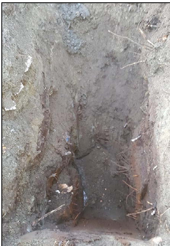
Figur 13: Prøvepunkt PG18. Fyllmasser av sand og grus med innslag av avfall i toppjord (0-1 m). Torv fra 1-2 m, og leire fra 2 m under terreng.
