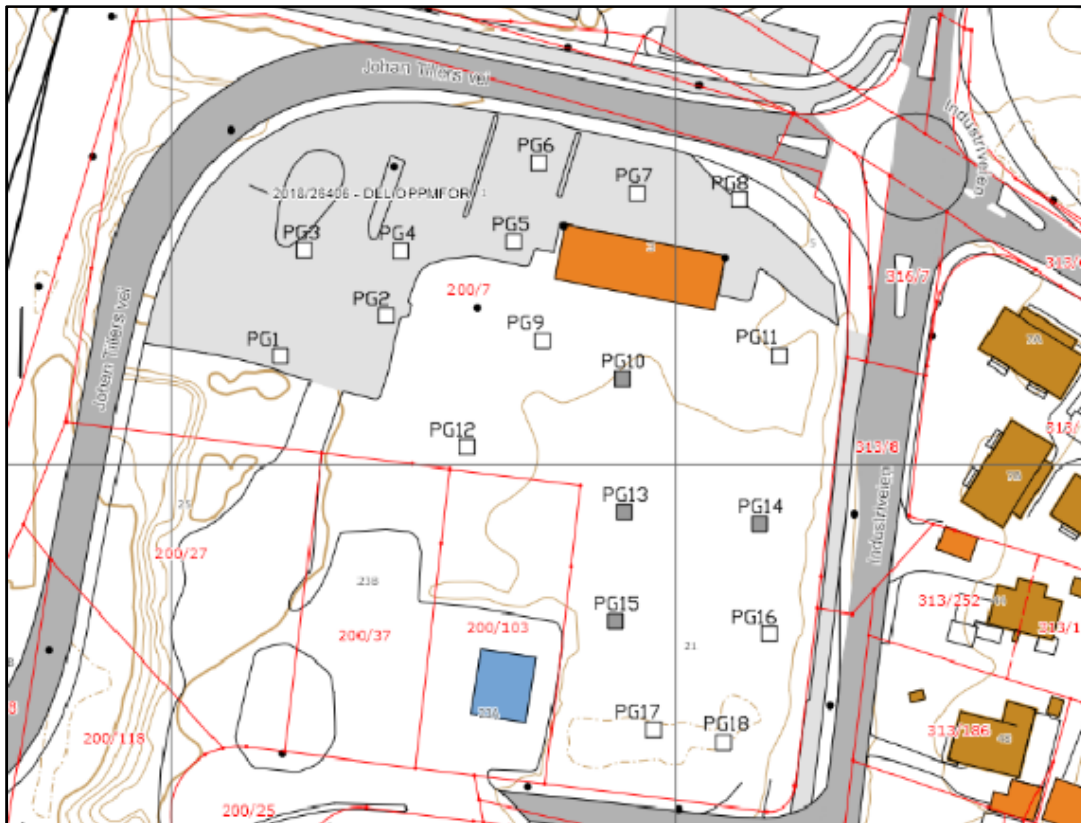
Figur 10: Utsnitt fra prøveplan. Prøvepunkter for miljøgeologiske undersøkelser (PG1-PG18) er markert med firkanter. Prøvepunkter markert med grått er ikke undersøkt.
