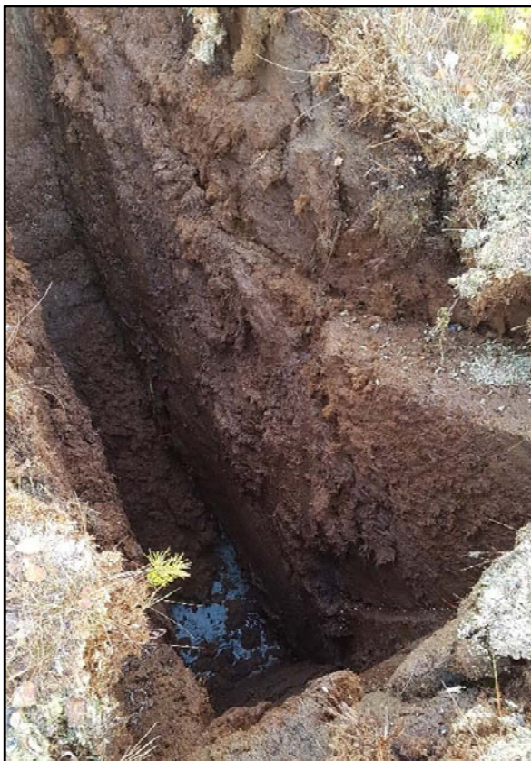
Figur 12: Prøvegrop PG12. Torv over leire. Torv ned til ca. 3 m under terreng.
