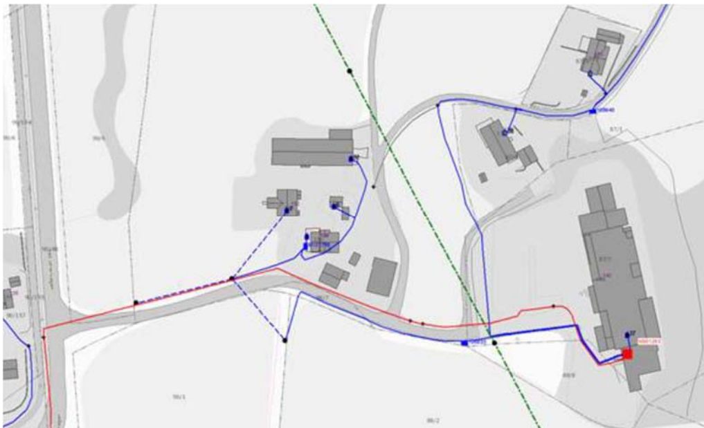
Figur: Illustrasjon fra Trønderenergi Nett som viser strømforsyning/kabler i grunnen med blå og røde streker, og høyspentlinje i luftspenn med grønn strek.
