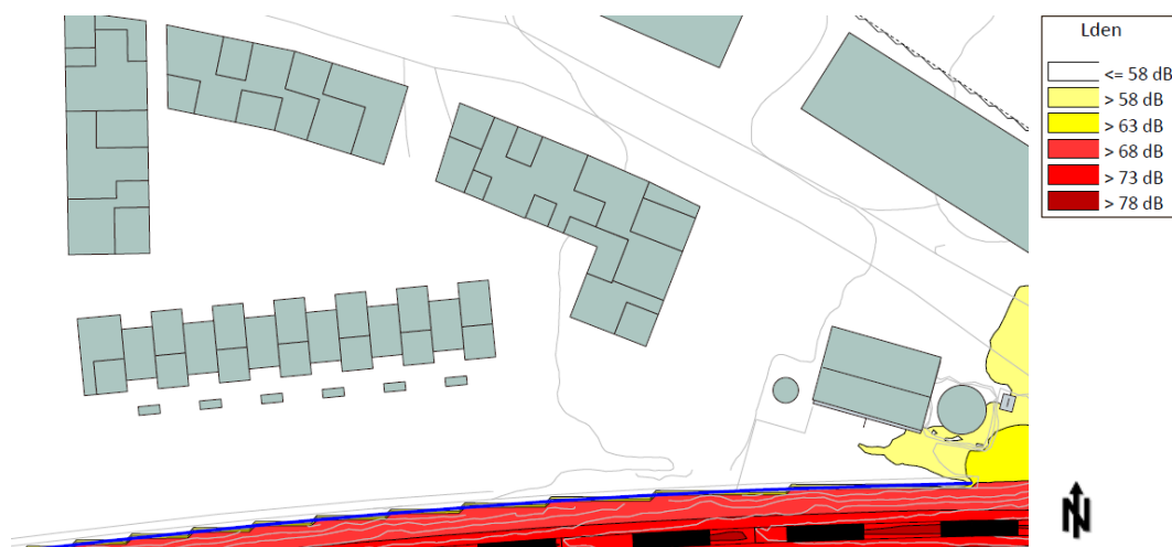
Figur 6 - Beregnet støynivå på uteareal, L_{den} , for jernbane. Beregningshøyde 1,5 m over terreng.
