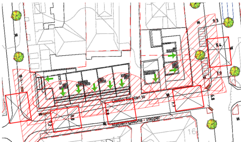
Planen viser arealbehov for brannvesenets høyderedskap (og rekkevidde) i Thomas Angells gate og Nordre gate.
