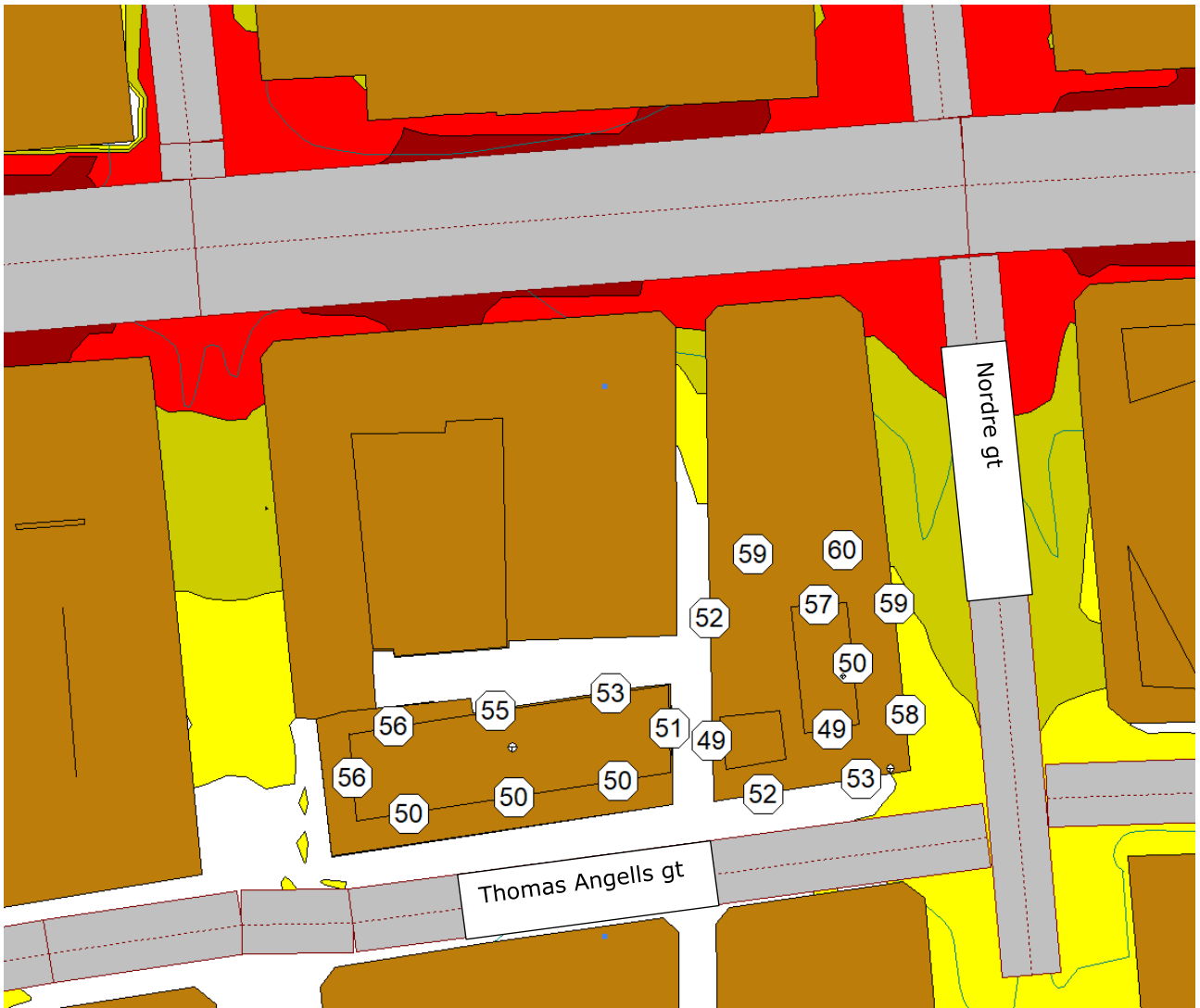
FIGUR 2: STØYSONEKART I 5. ETASJE, GUL SONE L_{DEN} 55DB- 65 DB, RØD SONE L_{DEN} \geq 65 DB
