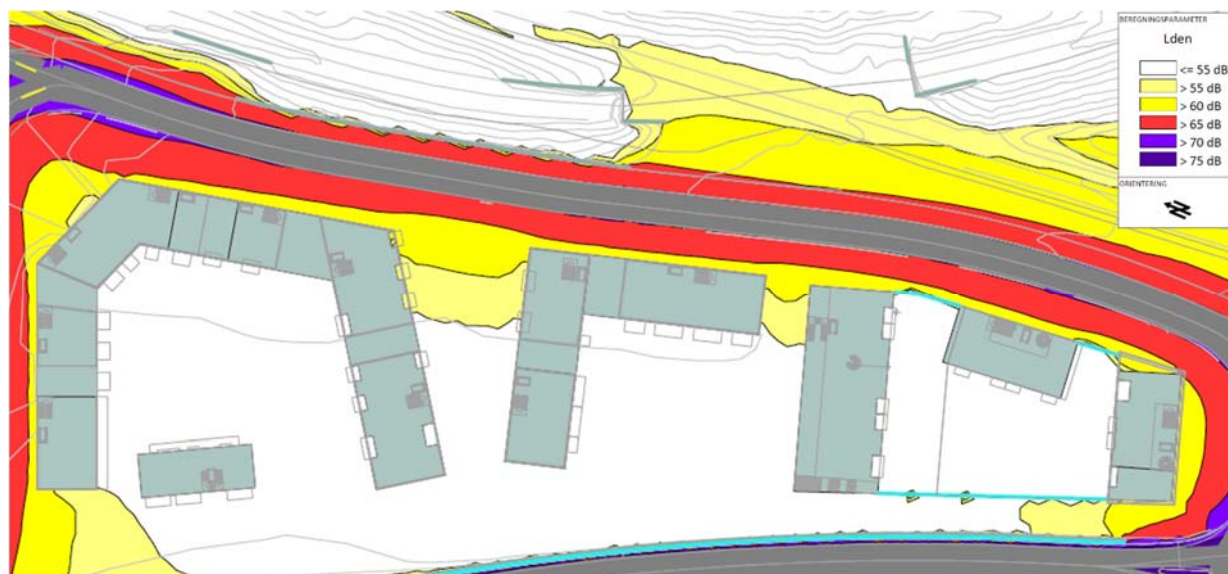
Figur 6 – Støy fra veitrafikk, L_{den} , på utendørs oppholdsareal med foreslått støyskjerm langs Rv706 (vist i turkis). Støynivå er beregnet 1,5 meter over bakkenivå og takterrasse.
