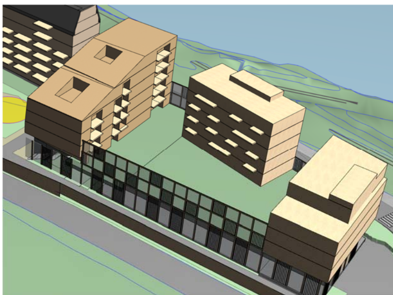
Figur 4 - Skjerm i glass som tetter mellom fasader på boliger over næringsetasjen mot sør.
