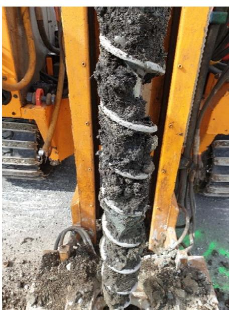
Figur 24 Prøvepunkt 13, dybde 6-7 meter, hvor det ble registrert jordmasser og stedvis leire, med innhold av treflis.
