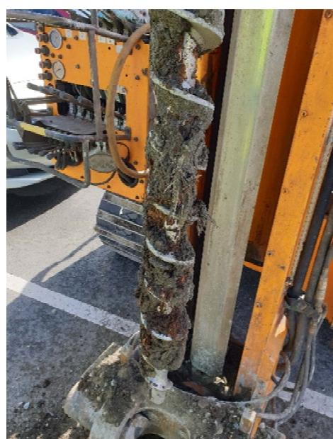
Figur 25 Prøvepunkt M16, dybde 1,5-3 meter, hvor det ble registrert jord og sand med innhold av treflis.
