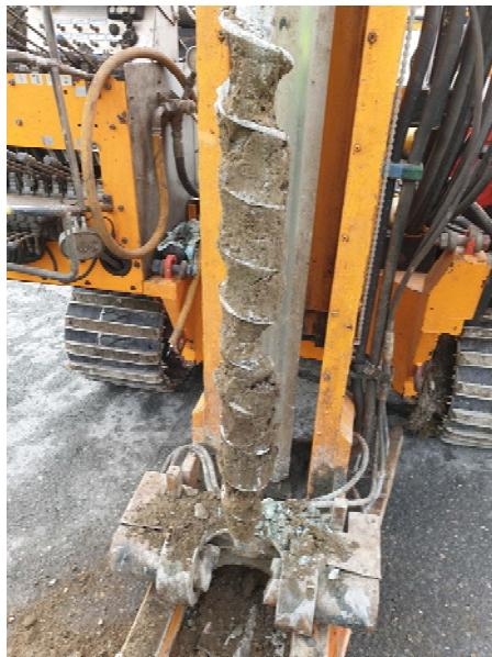
Figur 26 Prøvepunkt M22, dybde 1-2 meter, hvor det ble registrert grusig sand. Det ble registrert kreosotlukt av svarte fragmenter.
