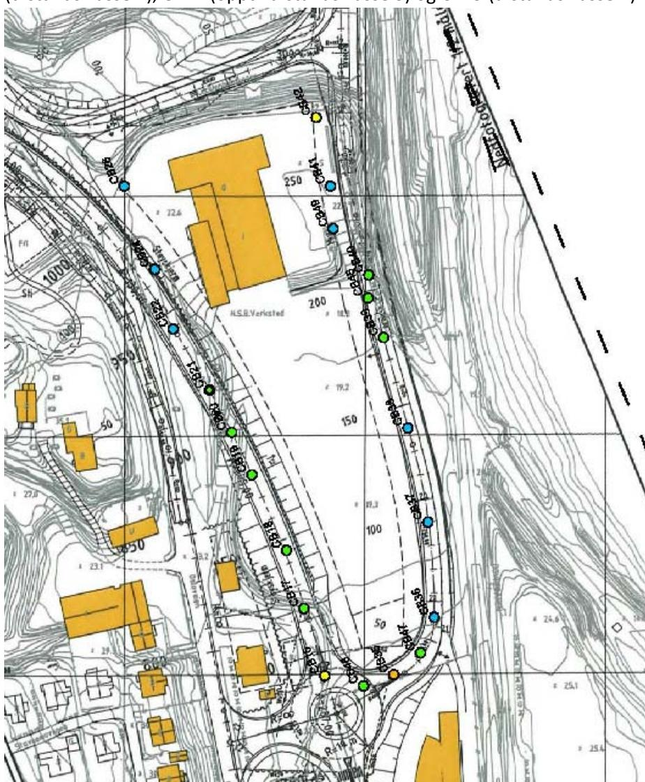
Figur 12 Prøvepunkt fra prosjektet Nordre Avlastningsvei, fargelagt iht. tilstandsklassen for forurensset grunn (TA-2553/2009).
