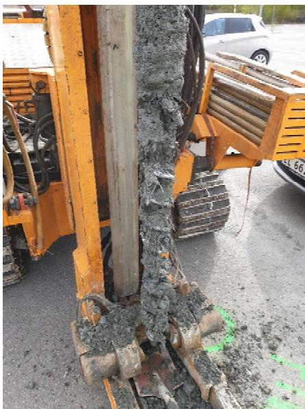
Figur 22 Prøvepunkt M11, dybde 2-3 meter, hvor det ble registrert betydelig innhold av treflis, samt oljelukt.
