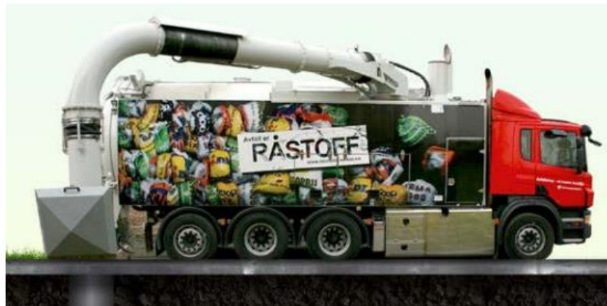
Figur 2: Mobilt avfallssug og dokkingspunkt (Trondheim Renholdsverk).
