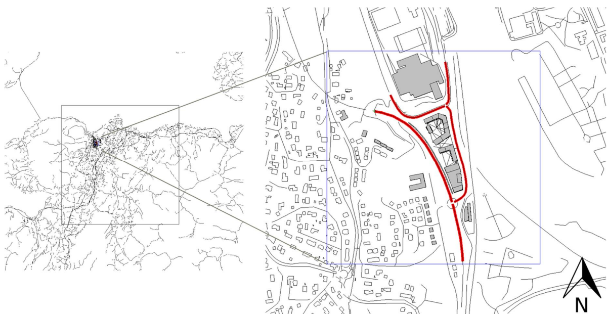
Figur 6. Oversikt over modellområdet for Cecilienborg i Trondheim kommune brukt i spredningsmodelleringen. Beregningsområdet for GRAMM er markert med rektangel til venstre, og for GRAL med blått rektangel til høyre. GRAL-illustrasjonen viser bygninger (grå) og utslippskilder (veger: røde, tunnelportal: grønn pil) i modellen markert.
