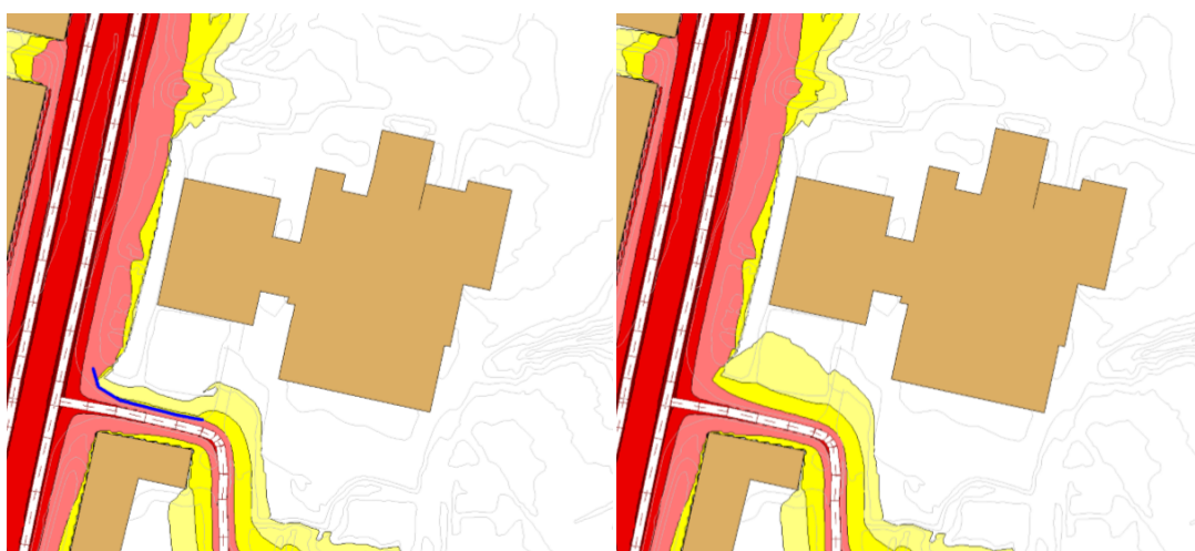
FIGUR 2: STØYSONEKART I 1,5 METERS HØYDE, SITUASJON MED TILTAK, STØYSKJERM/VOLL I BLÅTT GUL SONE Løen 55DB- 65 DB, RØD SONE Løen 265 DB
