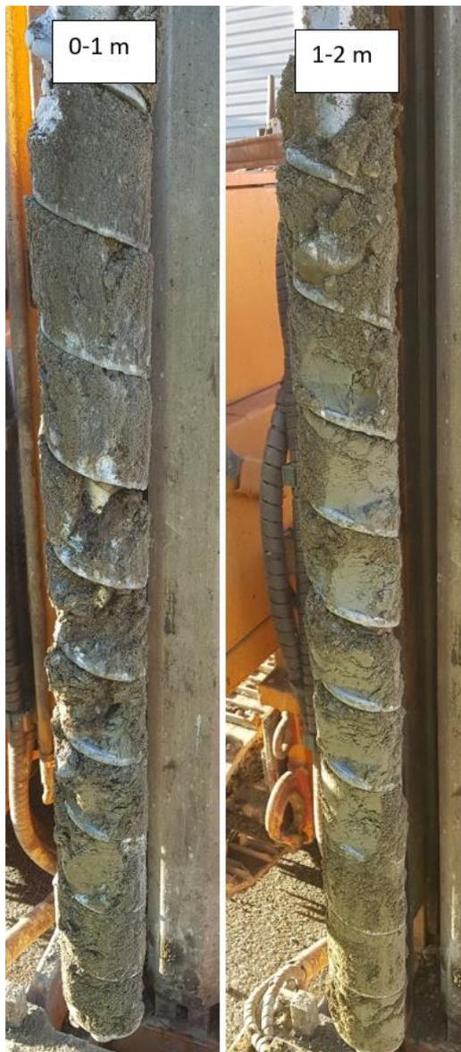
Figur 10: Borpunkt SK4. Til venstre 0-1 m: 0-0,6 m er fyllmasser av sand, grus og stein. Fra 0,6-1 m er det leire. Til høyre 1-2 m: Tørr, fast leire. Foto: Multiconsult.
