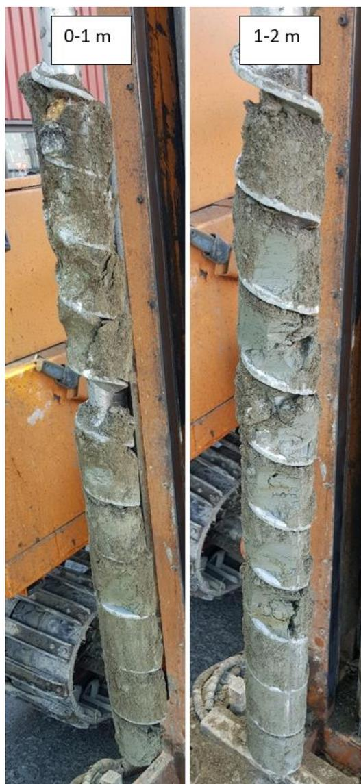
Figur 9: Borpunkt SK3. Til venstre 0-1 m: 0-0,5 m er fyllmasser av sand, grus og stein. Svak oljelukt. Fra 0,5-1 m er det leire. Til høyre 1-2 m: Tørr, fast leire. Foto: Multiconsult.
