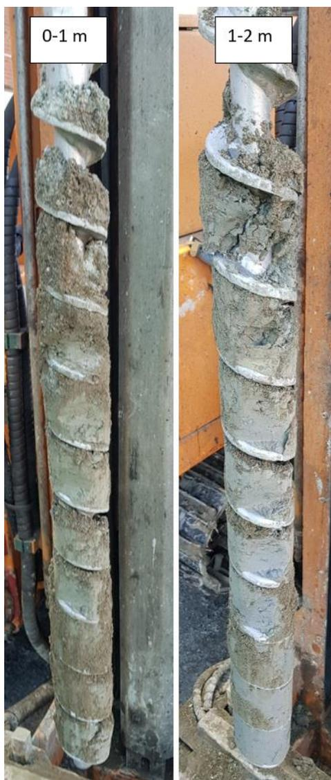
Figur 8: Borpunkt SK2. Til venstre 0-1 m: 0-0,2 m er fyllmasser av sand, grus og stein. Fra 0,2-1 m er det leire. Til høyre 1-2 m: Tørr, fast leire. Foto: Multiconsult.
