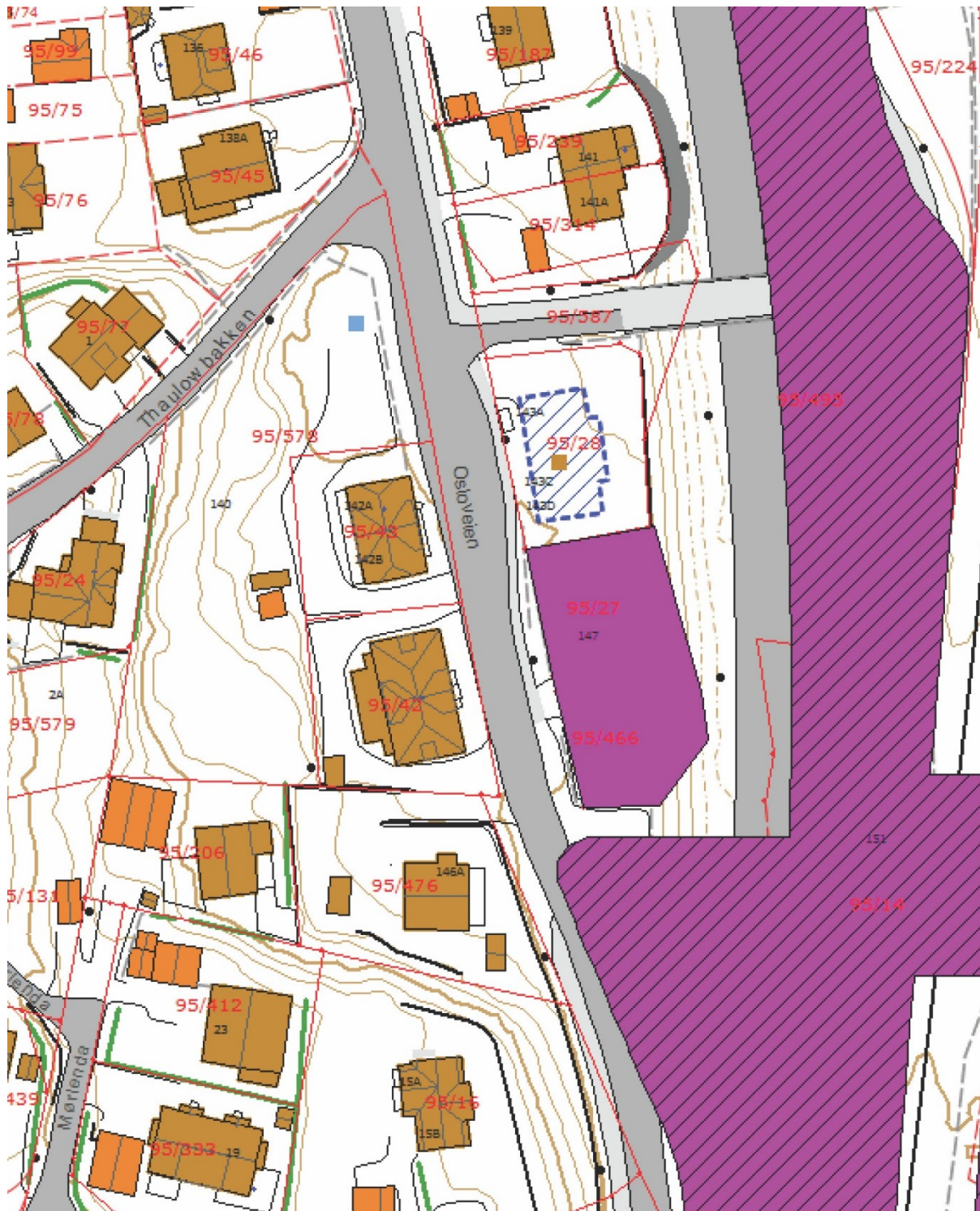
Figur 6: Forurenset grunn. Hhv. "historisk kartlegging", tidligere bilverksted (markert med lilla, uten skravur) og område omfattet tiltaksplan, tidligere industriområde (markert med lilla, og med svart skravur). Kilde Trondheim Kommune. Målestokk 1:1.000
