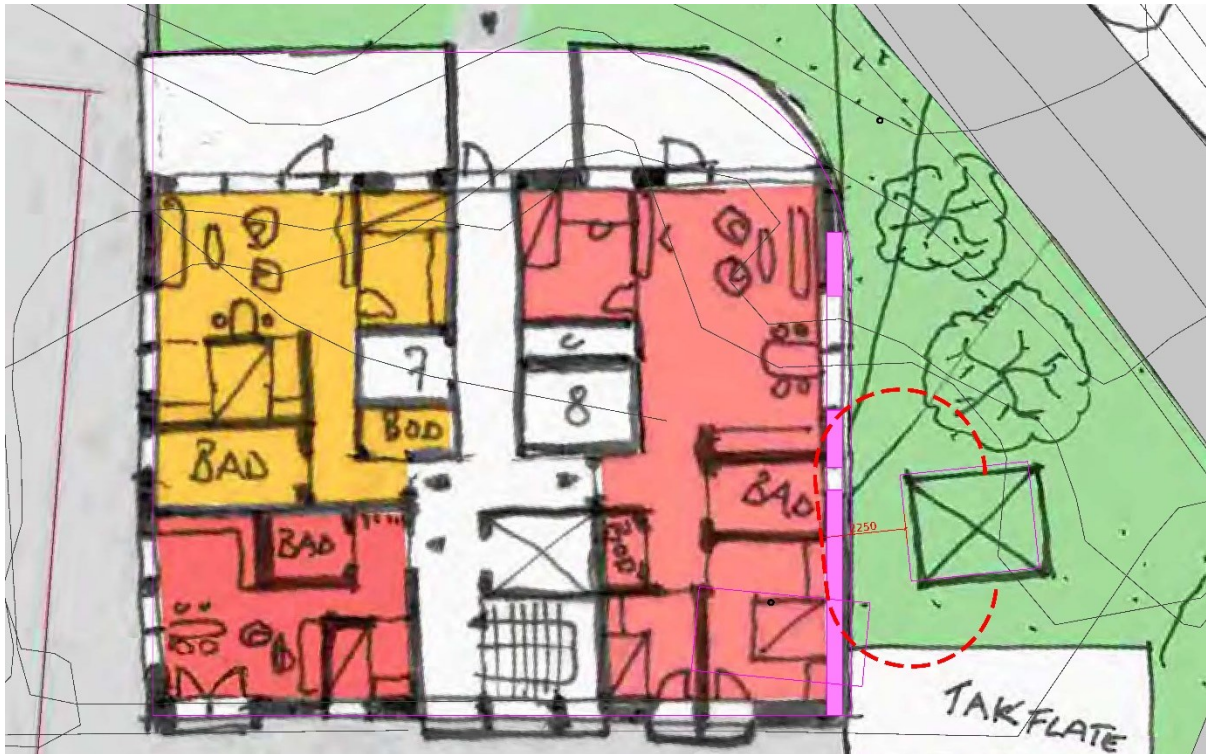
Figur 1: Skisse på 1. etasje i Bygg 1 med magnetfelt 0,4 \mu\text{T} (rød stipla linje). Nord er til høyre på tegningen. Målestokk 1:200
