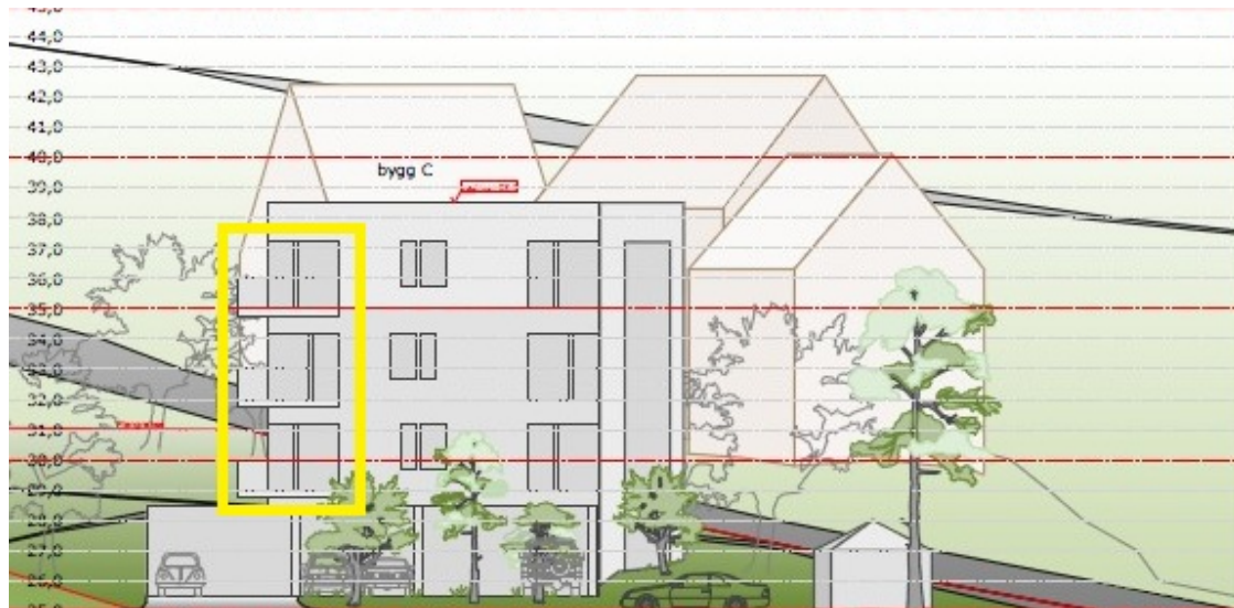
Figur 2: Illustrasjon av balkonger på bygg C berørt av gul sone
