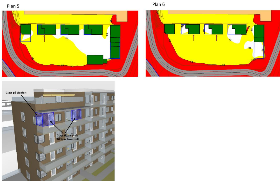
Figur 14 Øverst: Støysonekart plan 5 og 6 med markerte fasader. Nederst: Skisse med eksempel på skjermingstiltak for to av leilighetene i Hus 3 A plan 5.
