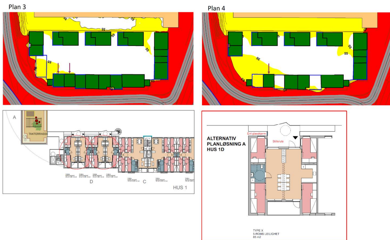
Figur 11 Øverst: Støysonekart plan 3 og 4 med markerte fasader. Nederst: Tiltak med inntrukket fasade.
