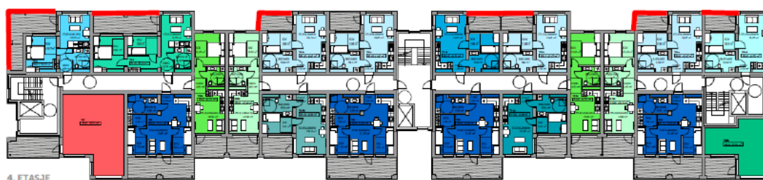
Figur 8 - Typisk planløsning for etasjene i Hus A. Innglassing markert i rødt.
