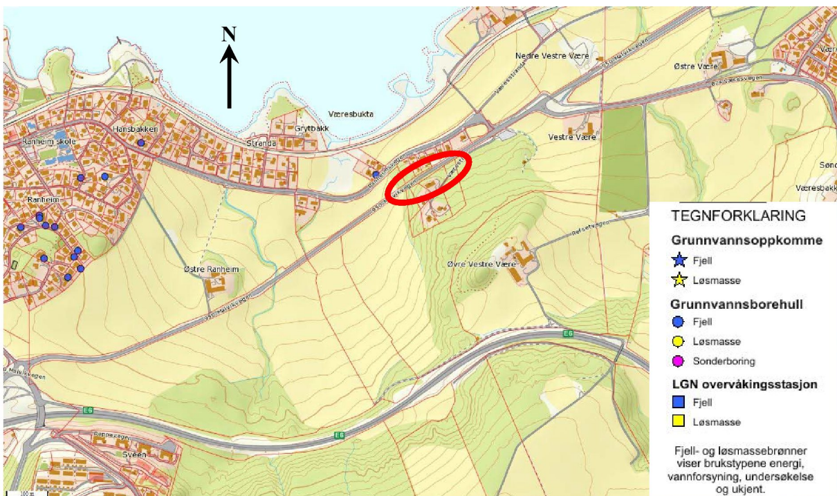
Figur 4 Utsnitt av kart i NGUs grunnvannsdatabase (GRANADA) [8]. Området ved bergskjæringen som skal utvides er markert med rød sirkel, og ligger omkring 100 m øst-sørøst for energibrønn i fjell på nordsiden av Ranheimsvegen.
