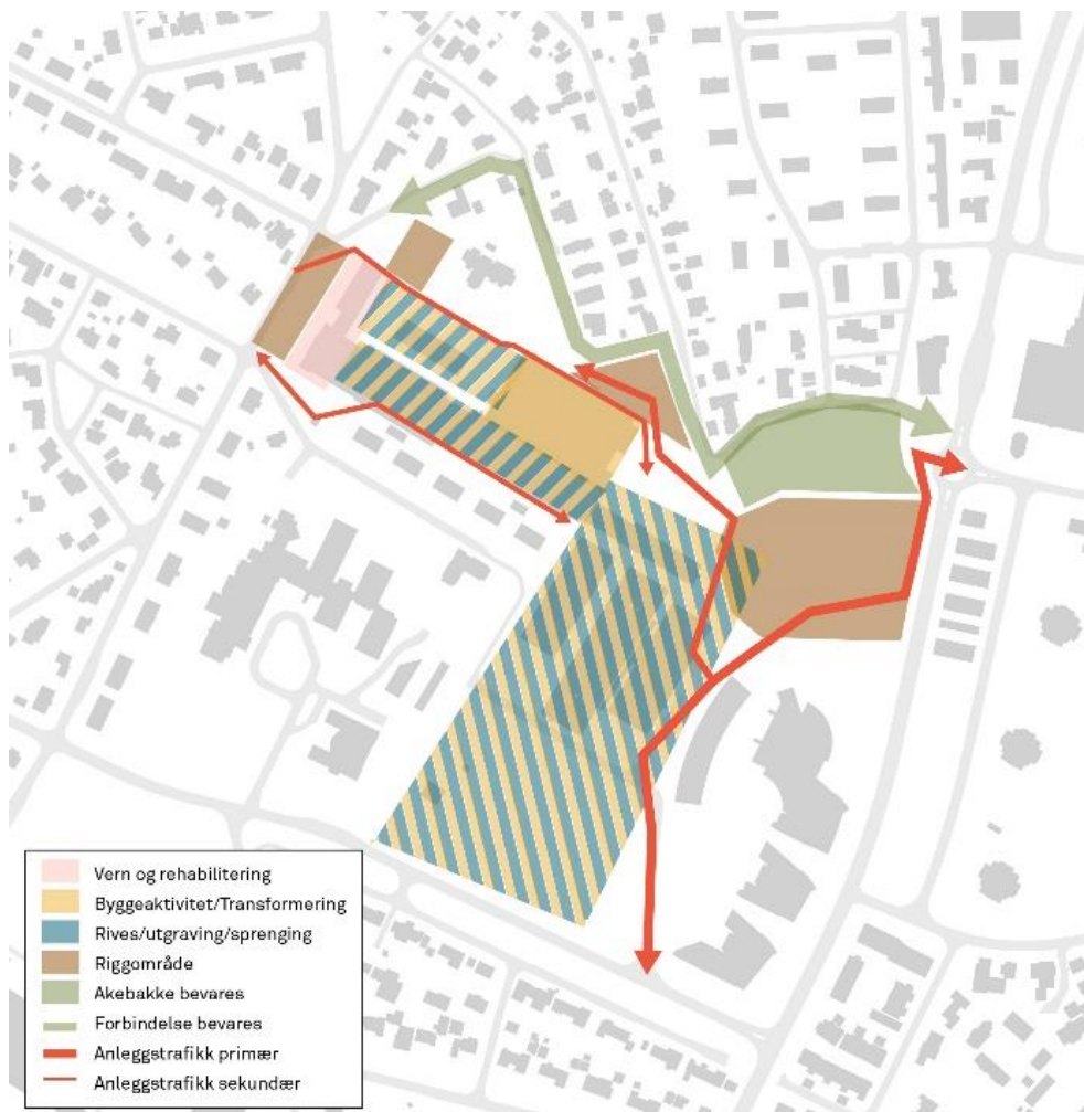
Figur 60: Anleggsområdet med anleggstrafikk
