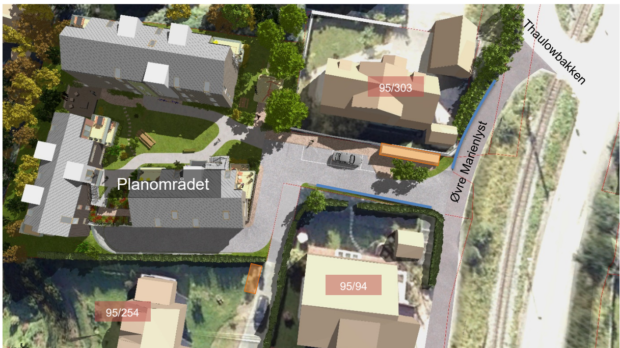
Figur 3: Utsnitt av ny situasjon fra prosjektets 3D-modell. Sør er orientert opp. Plassering av renovasjonsbeholdere er markert med oransje. Nye støttemuere i forbindelse med oppgradering av veg er markert med blå linjer.
