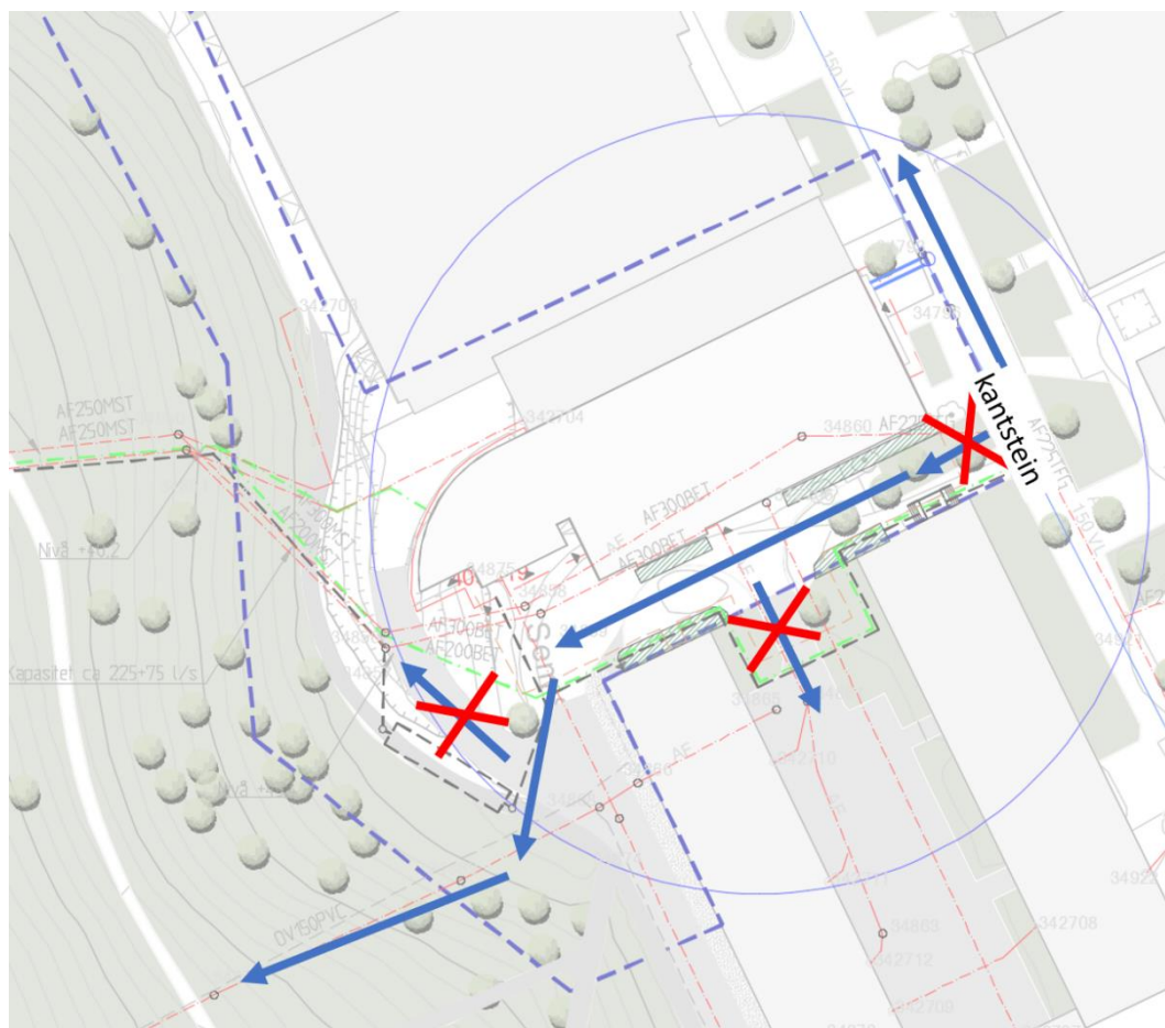
Figur 23. Avrenning for å forhindre oppstiving av overvann.
