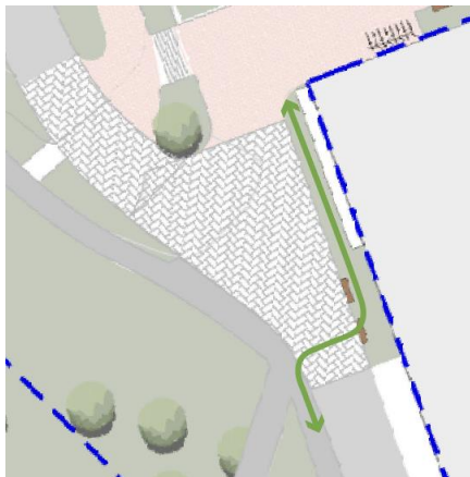
Figur 46: Grønn linje i illustrasjonen viser foreslått tilrettelagt gangmønster i fremtidig situasjon for å trekke myke trafikanter bort fra manøvreringsområdet til større kjøretøy.
