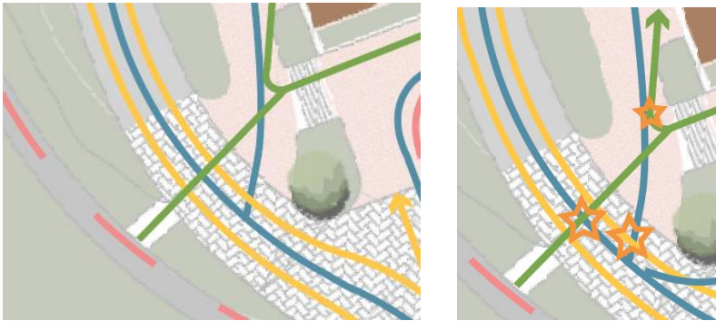
Figur 47: Trapp skissert inn som oppfordrer til gangmønster som krysser nedkjøringen til varelevering/renovasjon. Grønn er gående, gul er syklende opp/ned, og blå er varelevering/renovasjon.
