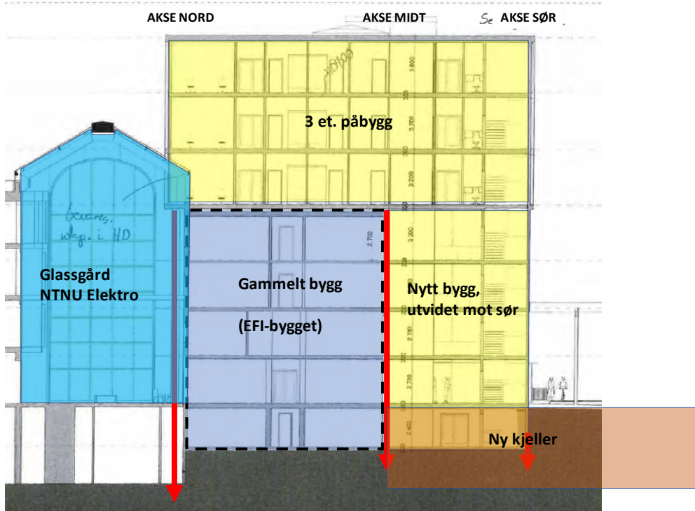
Figur 3 Oppriss over eksisterende bygg og nybygg
