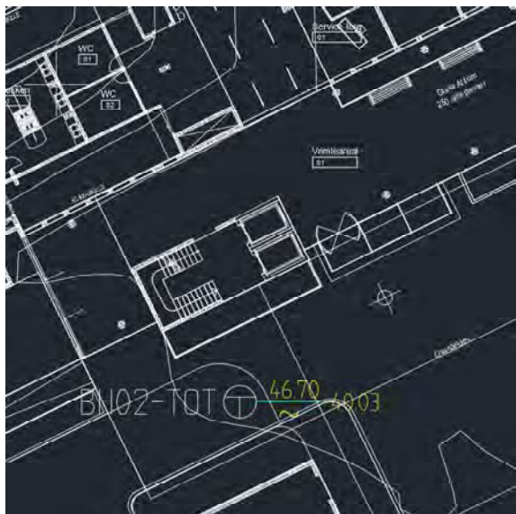
Figur 8 Plassering av ny heissjakt mot akse sør.
