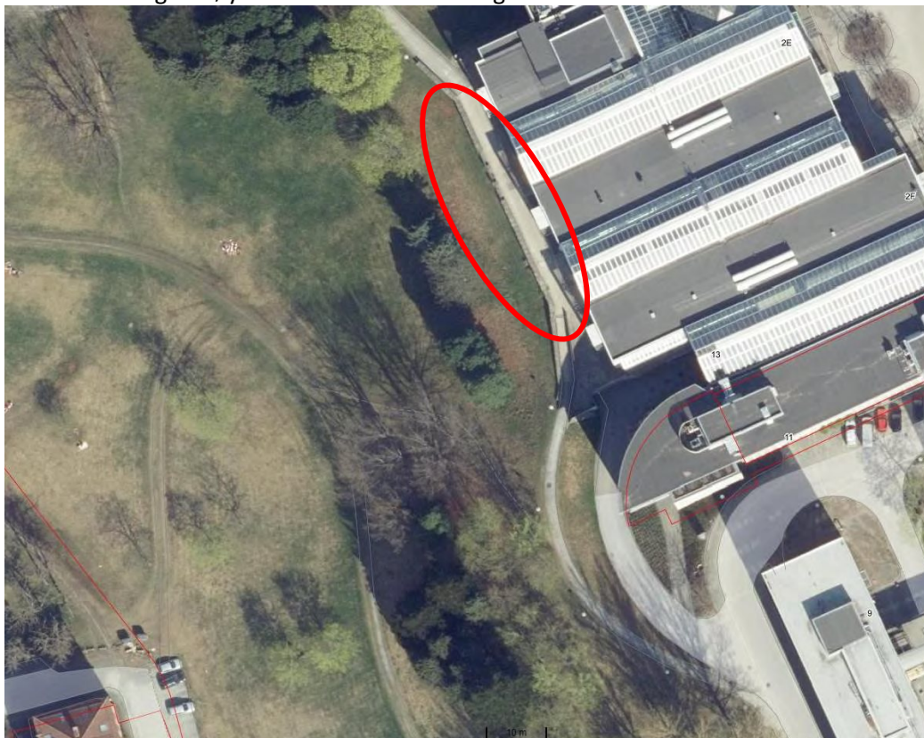
Figur 9: Flyfoto fra kart.finn.no. Rød sirkel viser plassering av fremskutt kjeller med betongdekke vest for Elektrobygget. I skråningstopp er det en lav støttemur.
