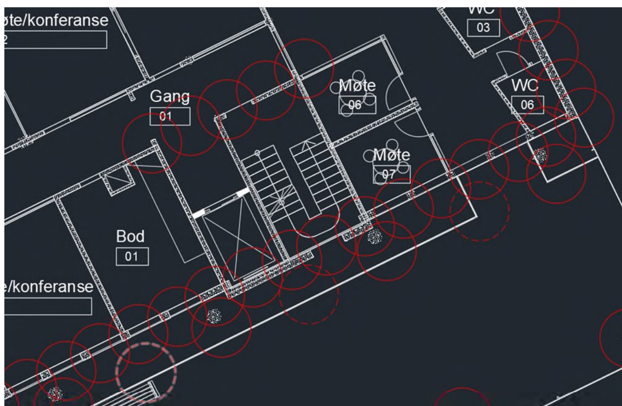
Figur 13 Gammel heissjakt – illustrasjon av underpinning inne i kjellergang og jetpelevegg under EFIs langside.
