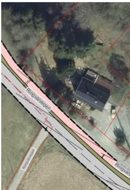
Figur 19: Eksempel på hvor utvidelse til sykkelveg med fortau vil kreve inngrep i terreng og grunnerverv ved Ringvålvegen 110
