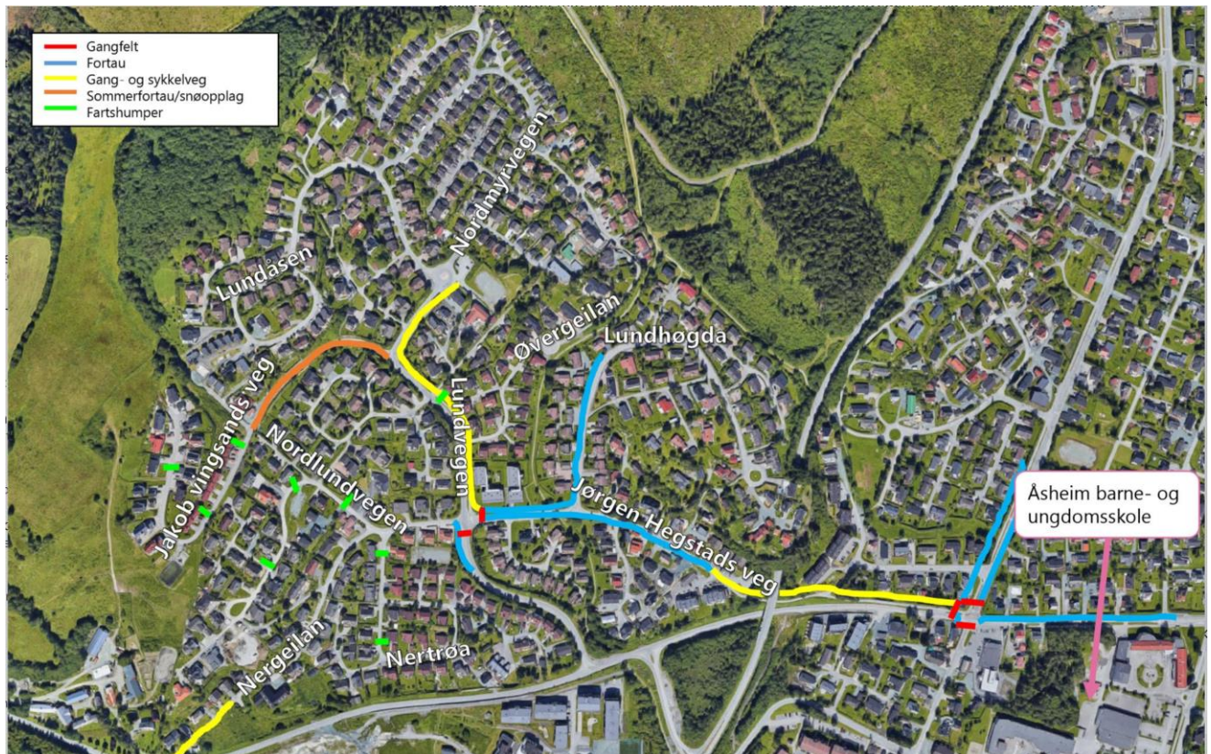
Figur 12: Eksisterende anlegg for gående og syklende på Lundåsen
