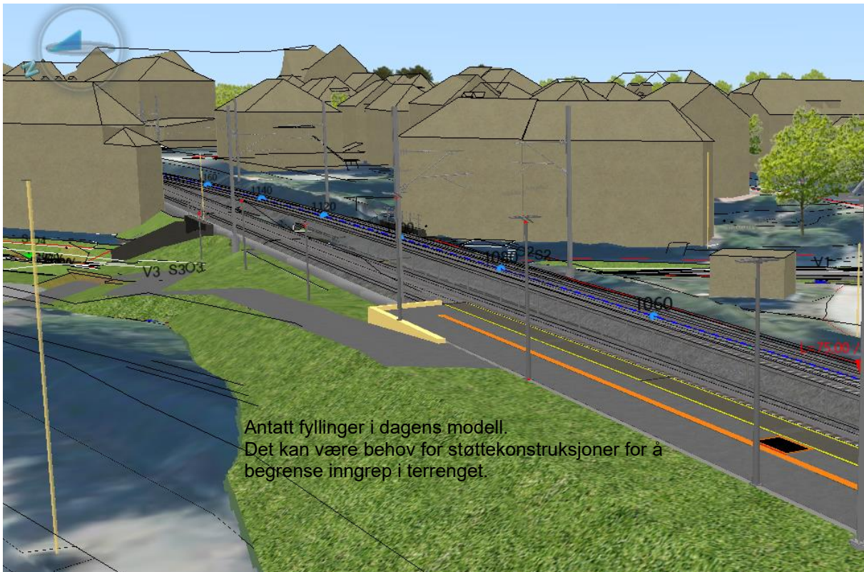
Figur 16: Det kan være behov for støttekonstruksjoner for oppstøtting for jernbanefyllinger for å begrense terrenginngrep. Skissen er hentet fra Quadri modell datert 27.06.2022.
