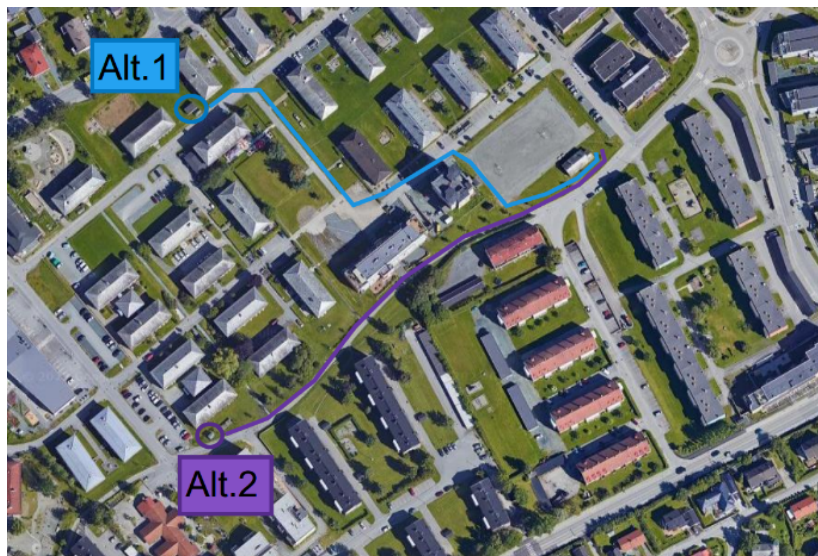
Figur 19: Alternativer for tilkobling til trafo
