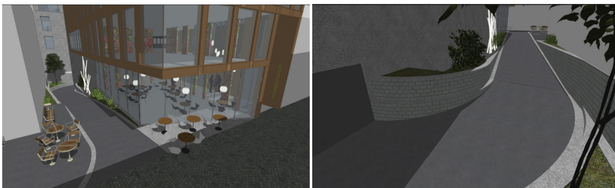
Nedkjøringsrampe sett fra Sommerveita (venstre) og fra bunnen av rampen (høyre). Nede ved porten skaper svingen en "blindsone", der man ikke blir sett fra gaten eller virksomheten i første etasje.
