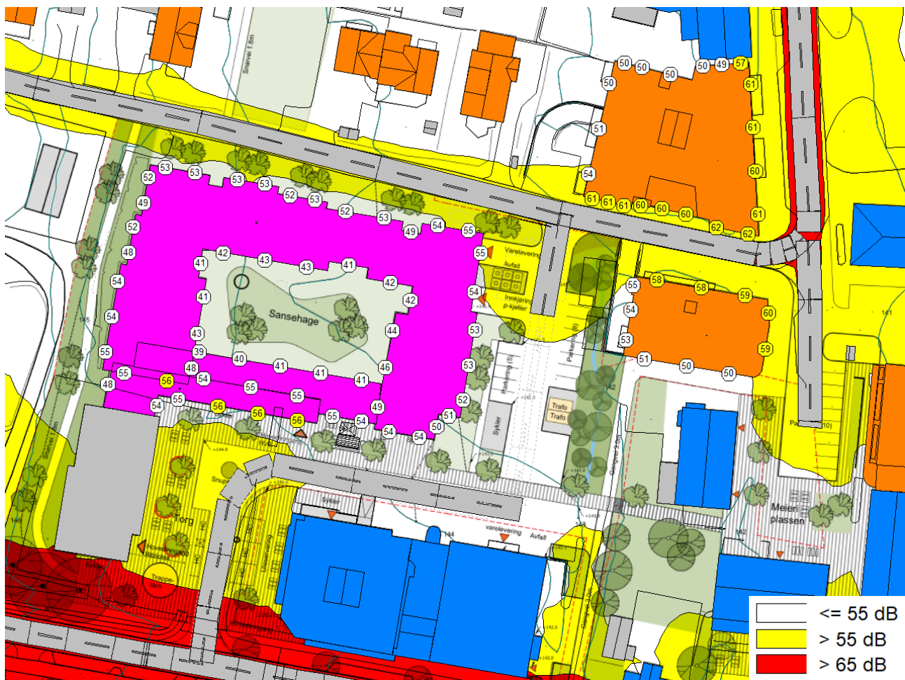
Figur 2: Støykart for fremtidig situasjon, gul sone beregnet 1,5 m.o.t. Høyeste fasadenivå vises.
