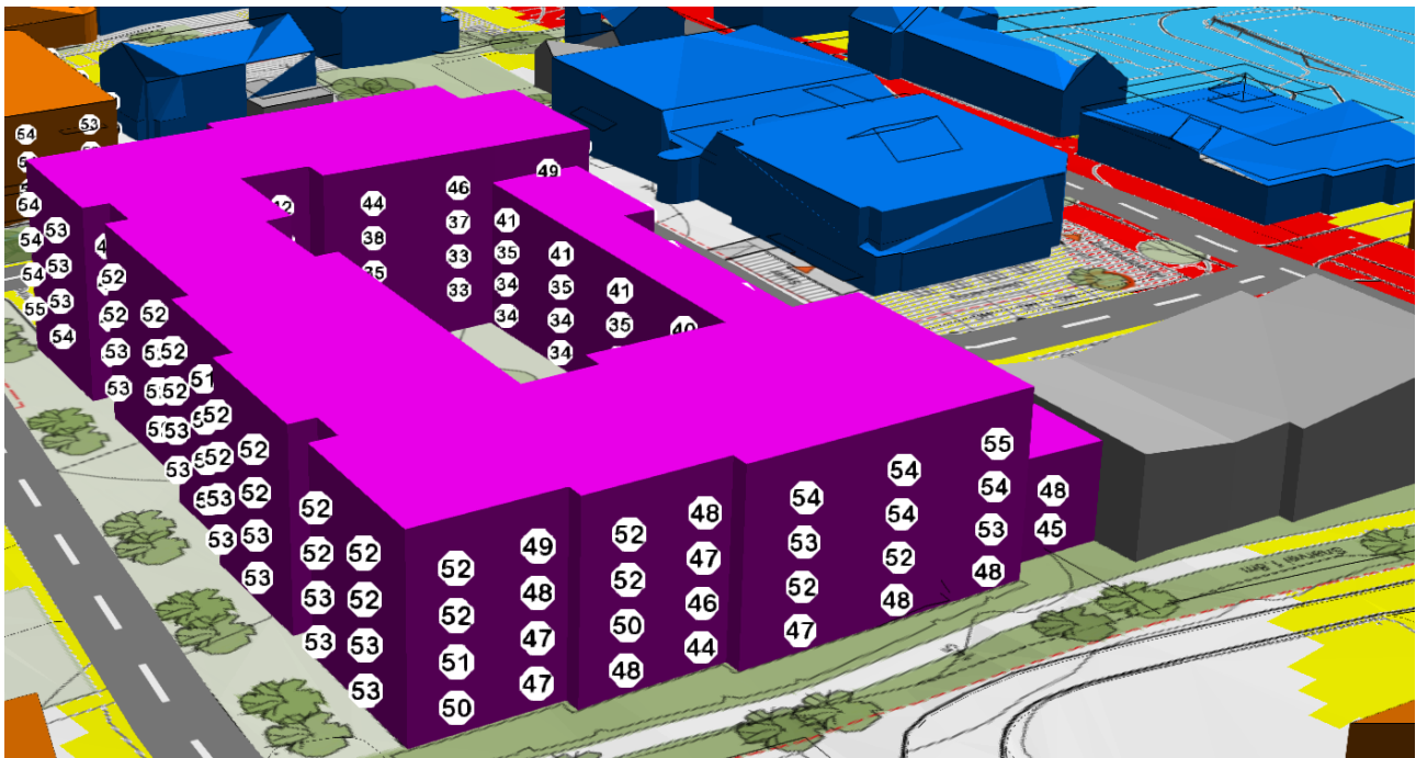
Figur 4: Utsnitt fra beregningsmodellen som viser beregnede fasadenivåer for alle etasjer, sett fra nord-vest.
