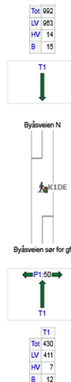
Figur 60 Trafikkmengde ved signalanlegg, ettermiddag fremtidig
