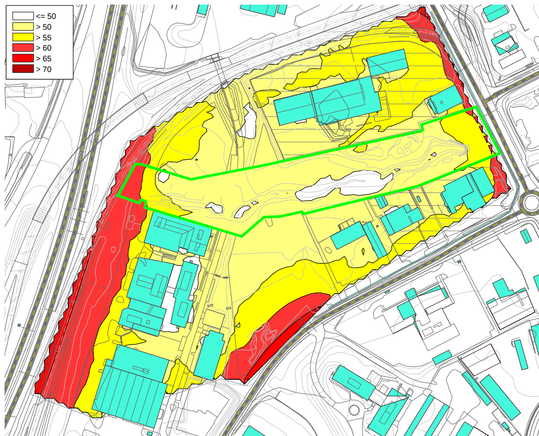
Figur 7 - Fremtidig situasjon med omkjøringsveien lagt i lokk og testing med 2,5 meter skjerm langs sluppenvegen og bratsbergvegen.
