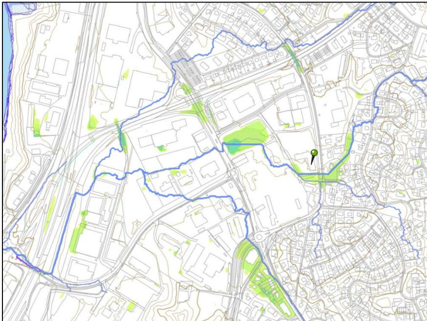
Figur 32. Tykk blå strek fra Nidarvoll skole og gjennom næringsområdet angir dagens flomveg. Ny kulvert for GS-veg under E6 fremgår ikke.
