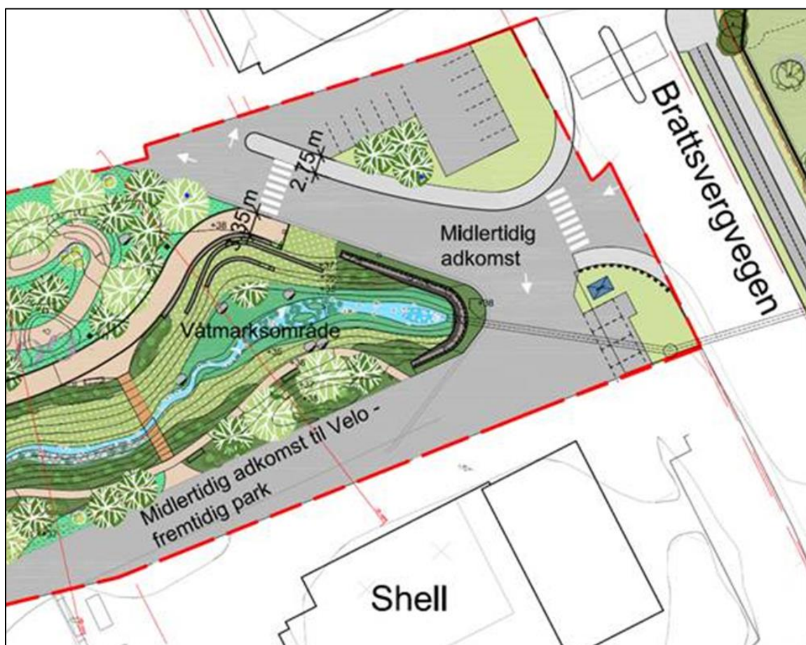
Figur 49. Midlertidig adkomst fra Brattsbergvegen til eiendommer på vestsiden (bl.a. Shell, Snapdrive og COOP)
