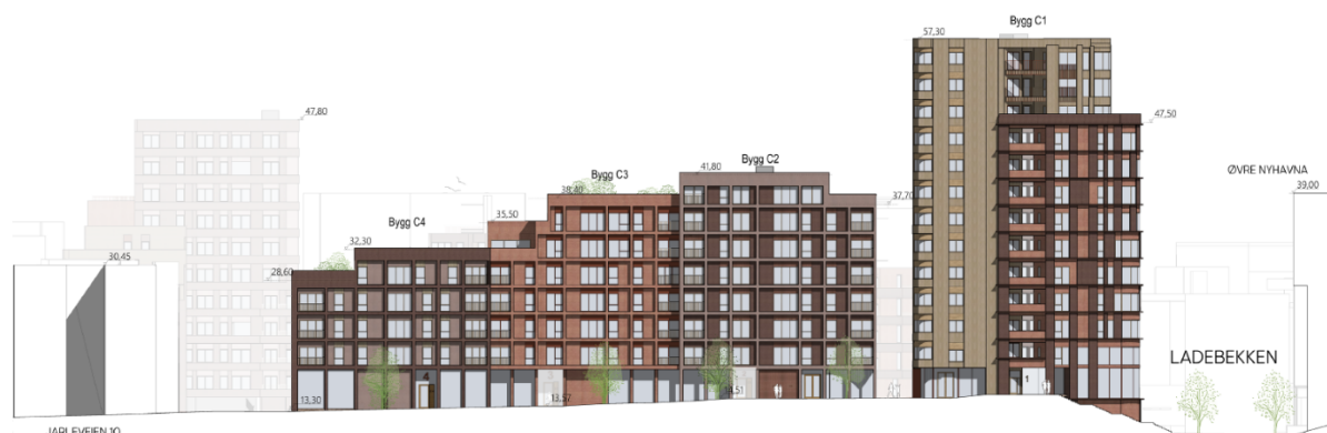
Illustrasjonen viser oppriss av bebyggelse mot Jarleveien. Opprisset viser at førsteetasjene følger terrenget.
