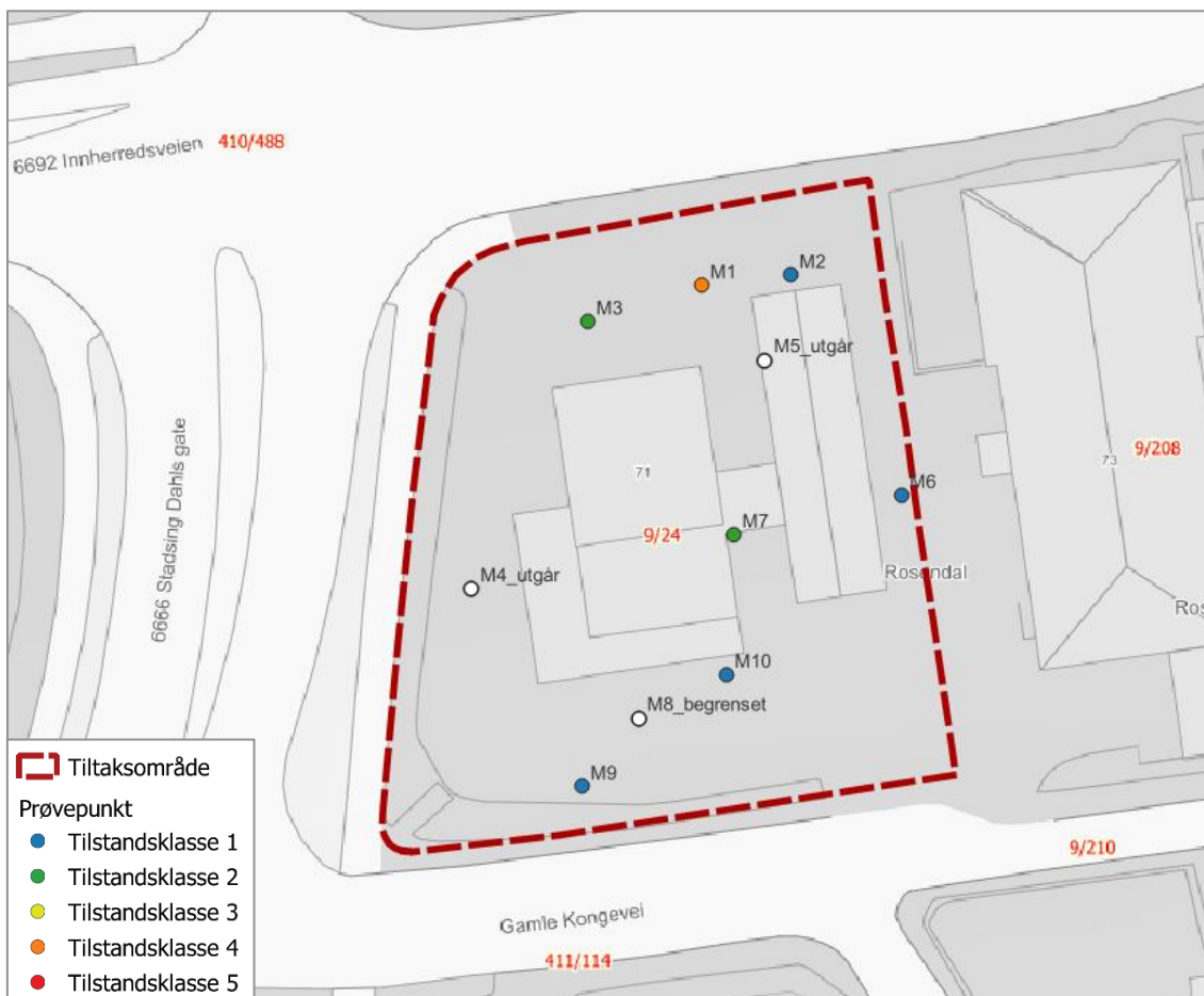
Figur 5-4: Situasjonsplan med prøvepunkter fargelagt etter høyeste påviste forurensningsnivå iht. Miljødirektoratets tilstandsklasser for forurenset grunn [2].
